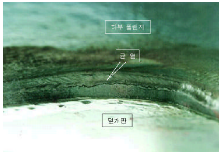
<그림3> 자분탐상시험 결과 사진
